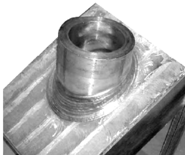
図 19 パイプの多層隅肉溶接
